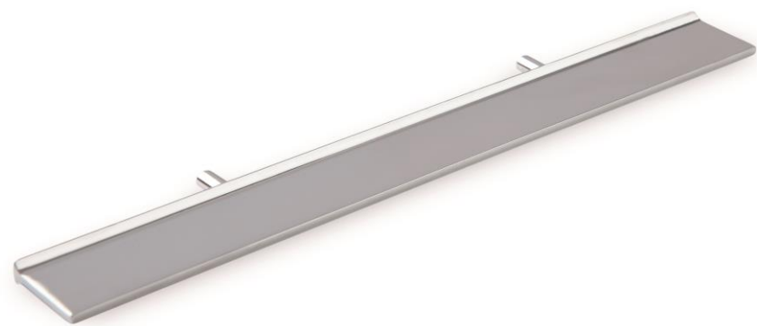
Ref. 879 Tirador ZAMAK 200 x 22 x 3 mm 96 mm entre taladros métrica 3 mm
