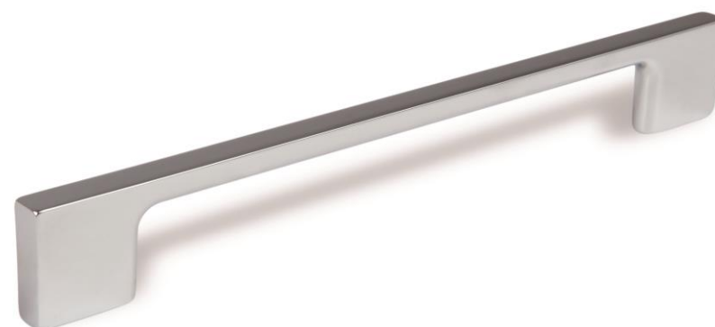
Ref. 607 Tirador ZAMAK 29 x 9 mm 266 x 256/224 mm entre taladros 201 x 192/160 mm entre taladros 130 x 128 mm entre taladros 106 x 96 mm entre taladros
